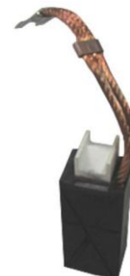
Электрографитовая щетка для двигателя электролокомотива
